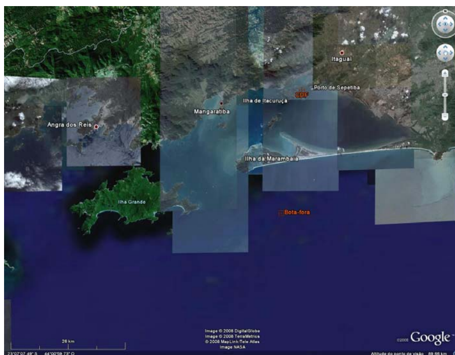
Figura 1: Pontos de descarte do material dragado. CDF no interior da baía e Bota-fora na região costeira adjacente.
